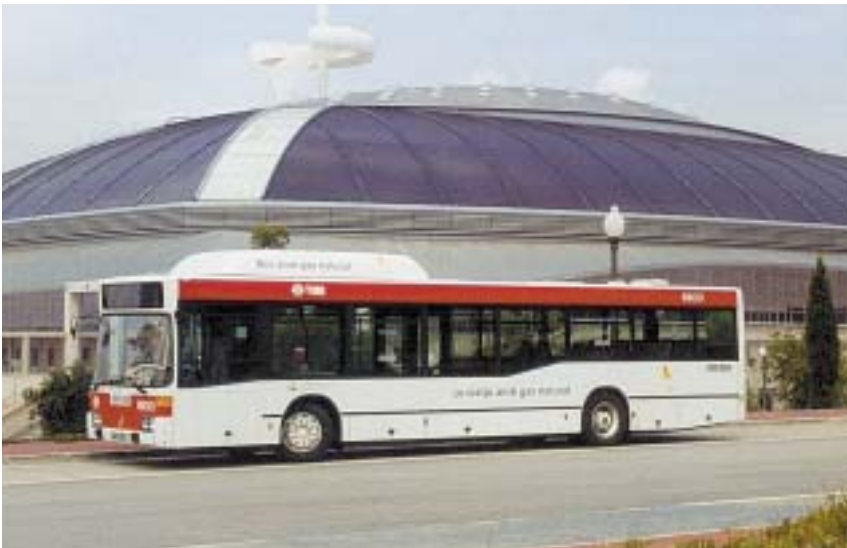
La flota d'autobusos de Transports Metropolitans de Barcelona comptarà l'any 2004 amb 250 vehicles a gas natural. Els avantatges que presenta respecte d'altres combustibles són la disminució del nivell d'emissions i una reducció del soroll del motor.
