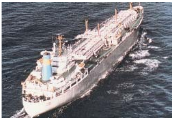
El primer vaixell metaner construït a Espanya va ser el "Laietà", que encara fa el recorregut entre Líbia i Algèria i la planta de Barcelona. Té una capacitat de 40.000 m 3 , volum que, una vegada regasificat, representa més de 20.000.000 m 3 .
