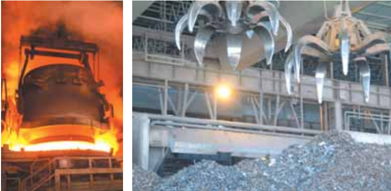
Izquierda: Carga de una cesta de chatarra en el horno de arco eléctrico (instalación que concentra el 70 por ciento del consumo de energía eléctrica). Derecha: Imagen del parque de materia prima férrica. Se observan dos pulpos maniobrando para coger chatarra y depositarla en las cestas que hemos visto en la fotografía anterior, con capacidad para 60 toneladas.
